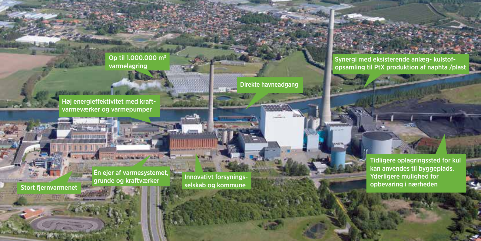
Figur 14. Kraftværkspladsen i Odense er en af mulighederne for placering af PtX-anlæg. Luftfotoet illustrerer, hvor tæt PtX og fjernvarme kan placeres på de eksisterende kraftværkspladser. Kilde: Fjernvarme Fyn
