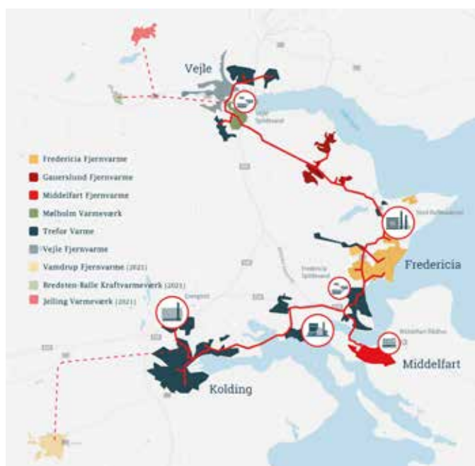
Figur 19. Varmetransmission i Trekantområdet forbinder varmeproduktion og lokale fjernvarmeområder via TVIS' fjernvarmenet (røde linjer). Kilde: TVIS.net
